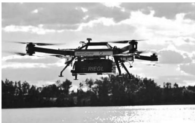
Figura 2 – UAV de aquisição de dados topo-hidrográficos ( RIEGL BathyCopter )
