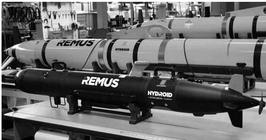
Figura 4 – UUV de aquisição de dados hidrográficos (Kongsberg REMUS)
