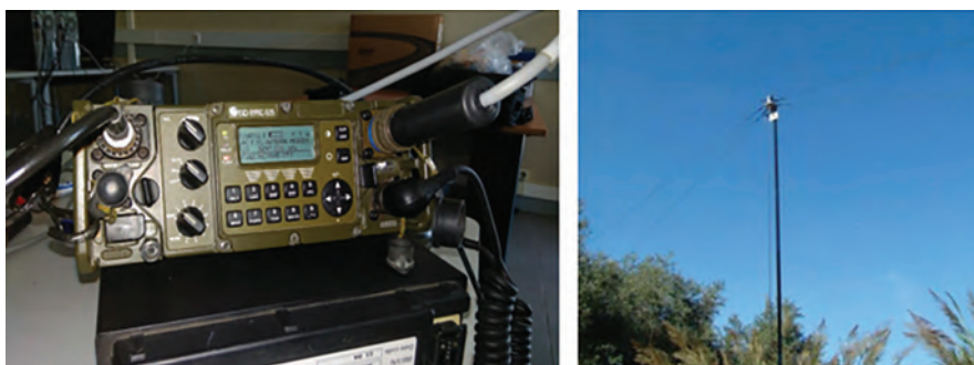
Figura 12 – Rádio E/R GRC-525 e antena dipolo RF-1936P
