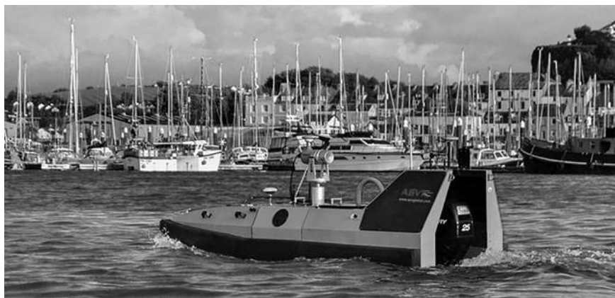
Figura 3 – USV de aquisição de dados topo-hidrográficos (ASV C-Target 3)
