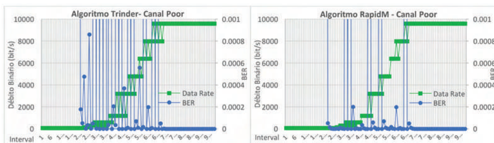
Figura 8 – Variação de BER vs. Débito Binário, para uma variação de SNR crescente e um canal ITU Poor
