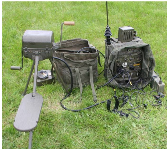
Figura 10 - E/R de HF, AN/GRC-9, pronto a operar
