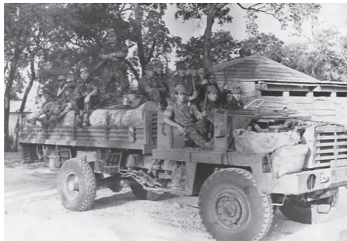
Figura 11 – Reforço de viatura com sacos de terra e remoção de portas e capô
