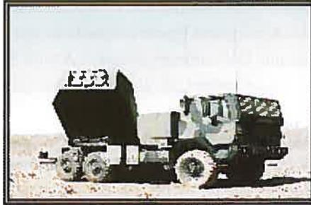
**Figura 8: O HIMARS montado numa viatura de 5 toneladas.**
