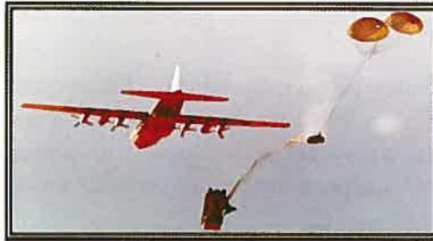
**Figura 5: Lançamento de uma viatura da família M113 por C-130.**
