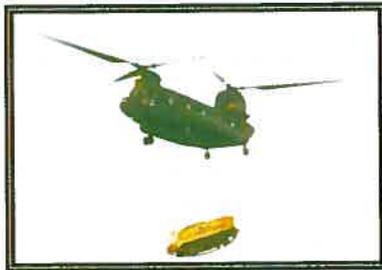
**Figura 7: Transporte externo de uma viatura da família M113 por CH-47 *Chinook*.**
