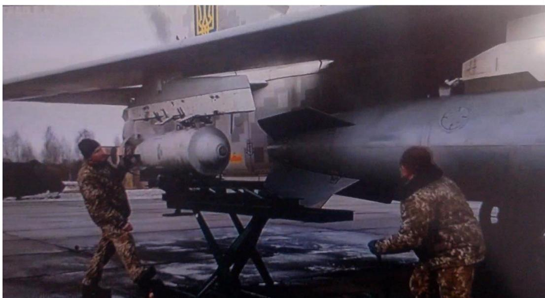
**Figura 3 – Mecânicos de armamento aéreo ucranianos municiando um Su-24 com bombas de aviação de alto explosivo não-guiadas. O Su-24 possui asas de flecha variável, estando estas aqui na posição mais recuada.**
