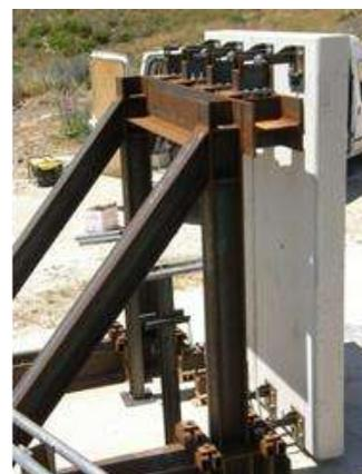
Figura 8 - Sistema de dissipadores metálicos em parede de betão
