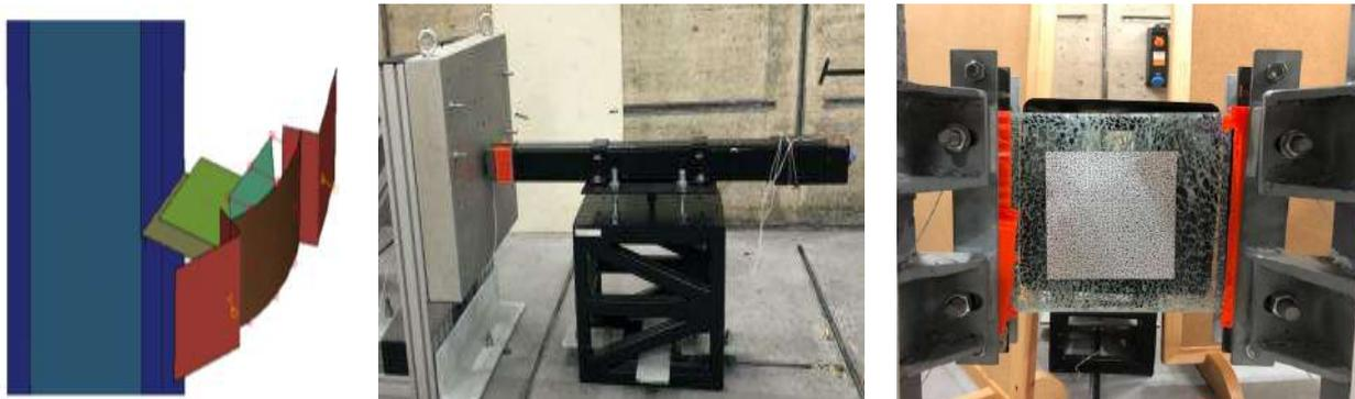
Figura 10 – a) Modelação numérica de uma solução de fachada "agrafada; b) Utilização de tubo de choque para análise dinâmica de dissipadores; c) Utilização de tubo de choque para análise dinâmica de painel de vidro
