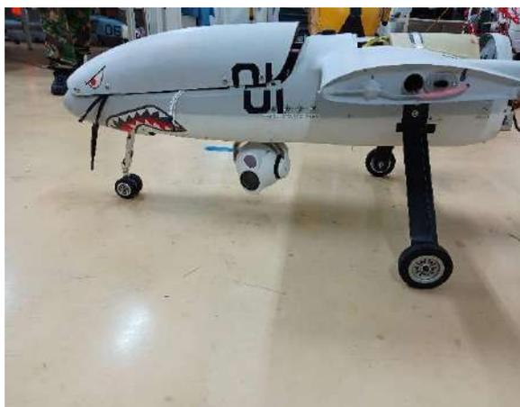
Figura 3 – UAV Alfa *Extended* equipada com sensor ótico do espetro visível e infravermelhos.
