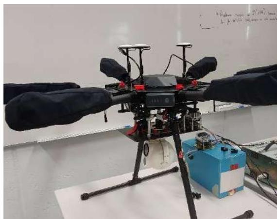
Figura 4 - UAV de asa móvel equipado com sistema computacional de bordo e sensor ótico do espetro visível e infravermelho.
