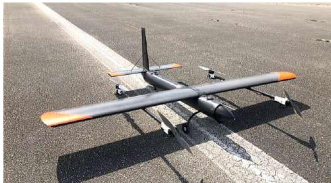
Figura 3 – Protótipo do UAV VTOL elétrico.
