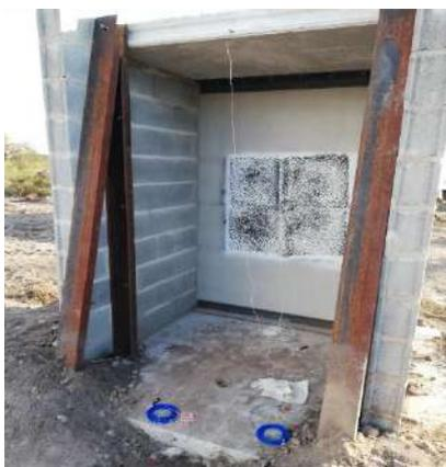
Figura 7 - Utilização de poliureia em paredes de alvenaria
