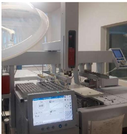
Figura 4 –Equipamento de Cromatografia Gasosa acoplado a Espectrometria de Massa
