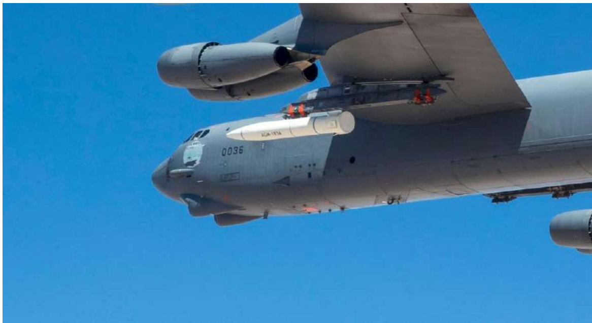
Figura 2 – B-52H municiado com AGM-183A Air-launched Rapid Response Weapon para ensaios Fonte: Retirado de https://www.cavok.com.br/lockheed-divulga-novas-imagens-de-sua-arma-hipersonica-agm-183a-arrw
