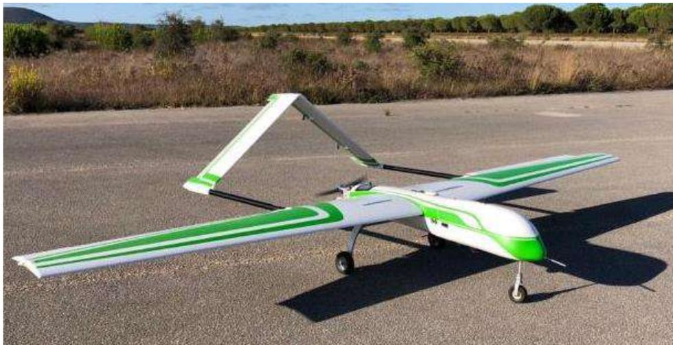
**Figura 3- UAS30 P2 em fase de testes de aceitação da aeronave**
