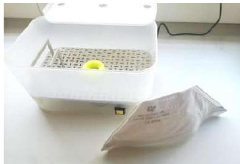
Figura 2 – Versão portátil de baixo custo da câmara de descontaminação capaz de descontaminar até 4 máscaras N95. A versão miniaturizada do gerador de vapor de peróxido de hidrogênio está integrada na câmara.
